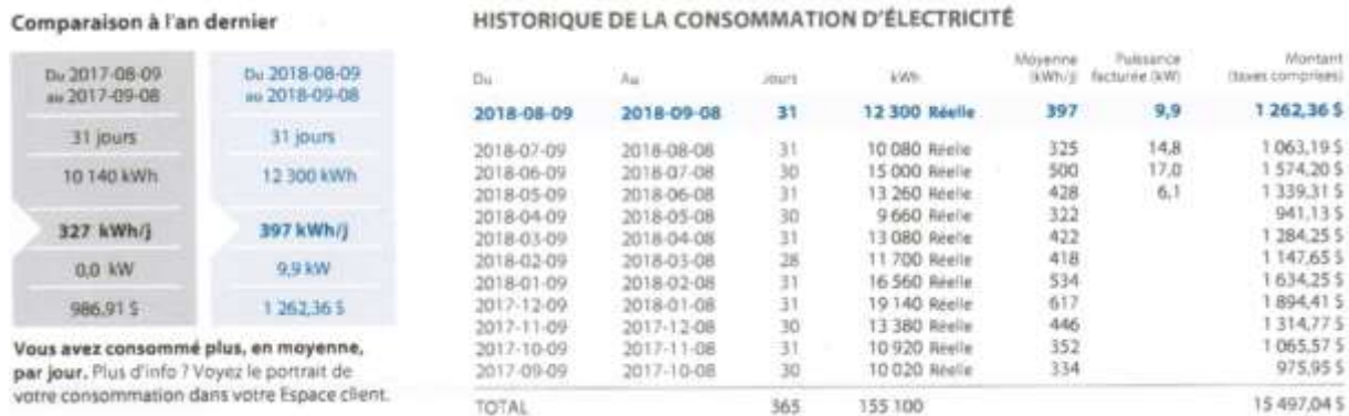
Figure 1 : Consommation électrique annuelle du bâtiment. La charge est supposée entièrement en courant alternatif. Extrayez la portion du coût imputable à la puissance facturée pour déterminer le coût au kilowatt-heure. Et supposez que les panneaux pourront éviter cette surcharge de puissance.
