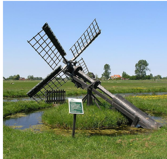
Tjasker – 1600 Pompage de l'eau
