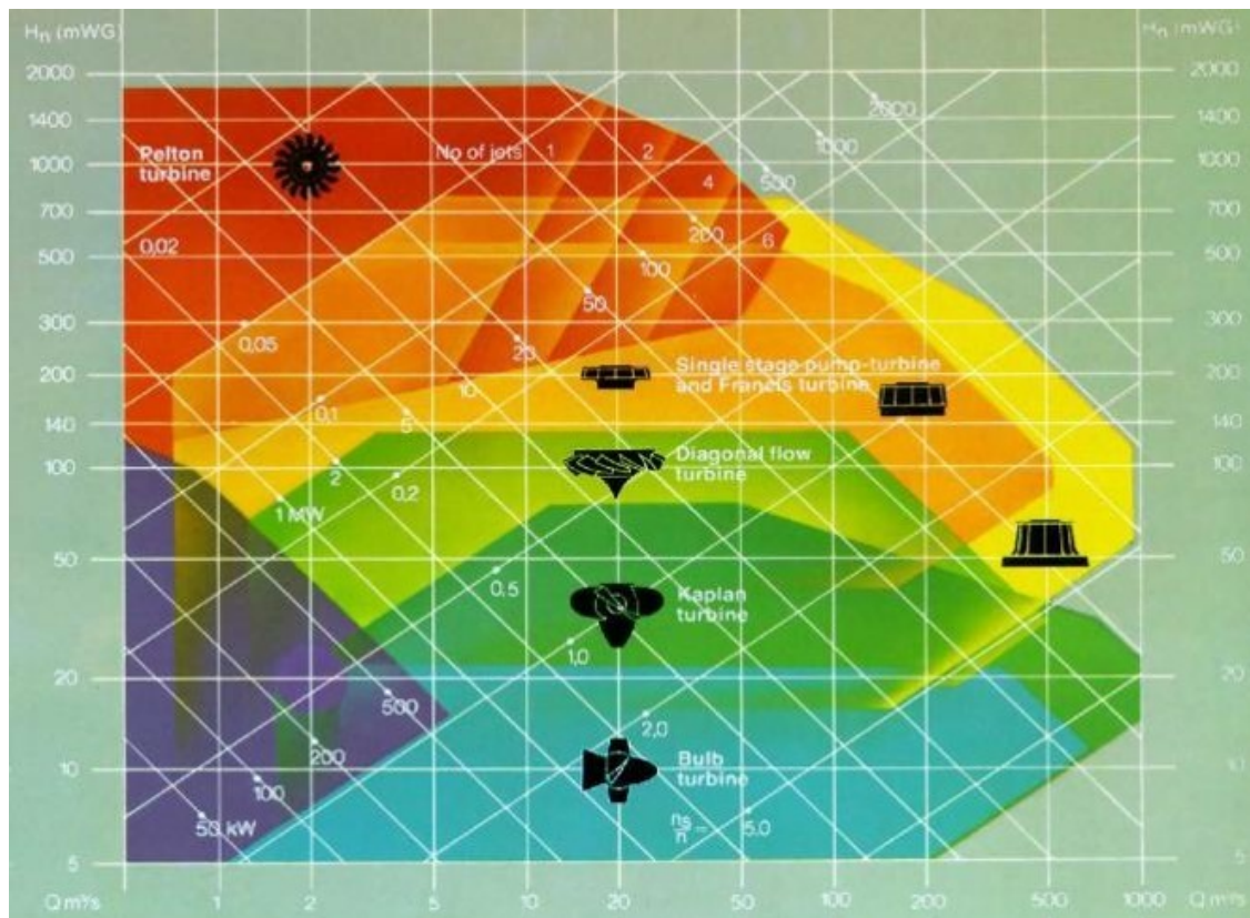
Domaine d'application des différents type de turbine
