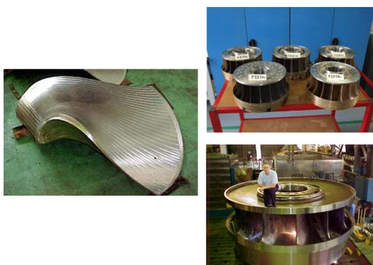
*Aube et roues modèles et prototype*
