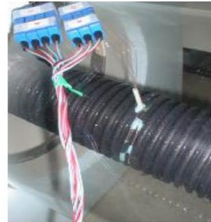
Étude expérimentale de la condensation dans un échangeur air-air
