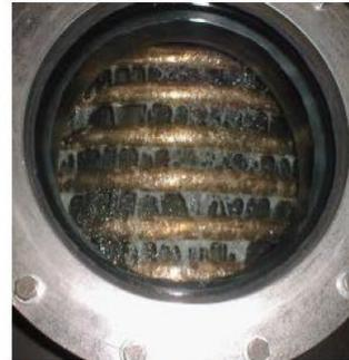
Échangeur hélicoïdal pour évaporateur utilisé pour produire de l'Eau surfondue,
