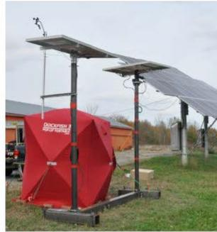
Évaluation de la performance d'un système PV avec suiveur solaire
