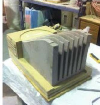
Moule du module de séparation de l'échangeur ESAV4 pour l'aviculture,
