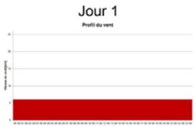
$$\text{Jour1 : } \frac{1}{2} 24 \text{ [h]} \times 6 \text{ [m/s]}^3 \times 1 \text{ [m}^2\text{]} \times 1,2 \text{ [kg/m}^3\text{]} = 3\,110 \text{ Wh} \approx 3 \text{ kWh}$$
