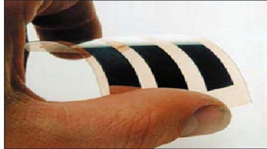
Cellule photovoltaïque polymère flexible sur PET+ITO, Univ de Linz
