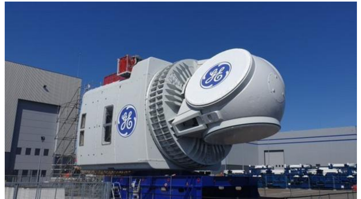
Éolienne Haliade X de GE-RE, 12 MW
