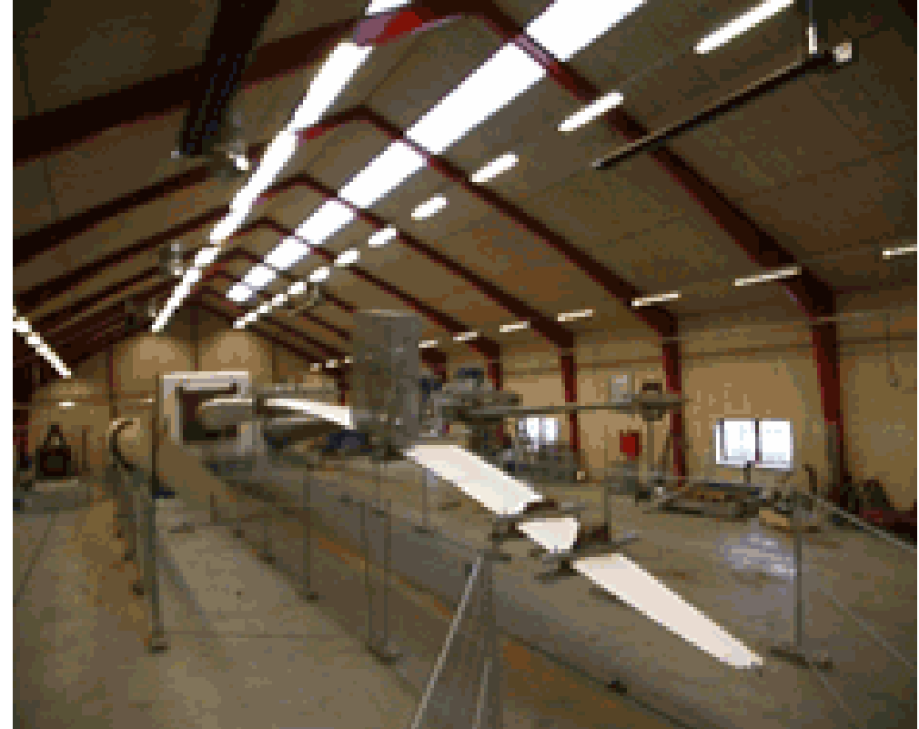
Test contrôlé de résonance sur pale
