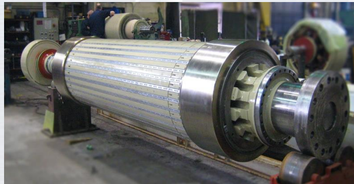
Rotor à pôles lisses (non saillants)
