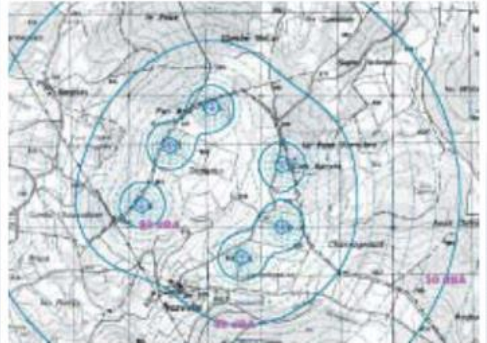
Courbes isophones autour d'une centrale éolienne
