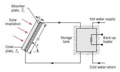
Considérons un collecteur incliné à un angle de  $\tau$  = 60° et ayant des dimensions H = w = 2 m sur un côté, avec une lame d'air de L = 30 mm.
