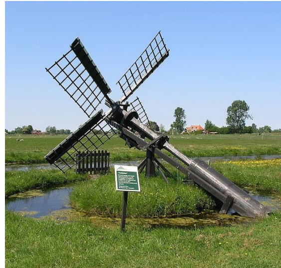
Tjasker – 1600 Pompage de l'eau
