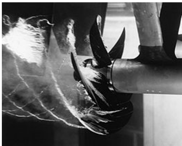
La cavitation un phénomène nuisible
