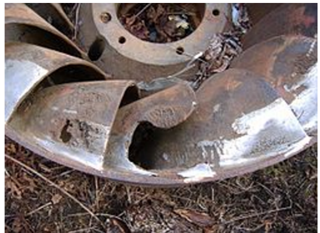
La cavitation un phénomène nuisible
