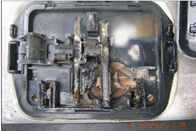
Ce boîtier montre un échauffement significatif qui s'est propagé jusqu'au panneau PV ; la marque thermique sur les cellules en face avant est très nette.
