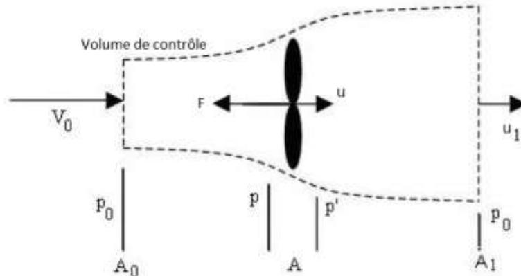
Fig. 1: Écoulement axial de l'air
