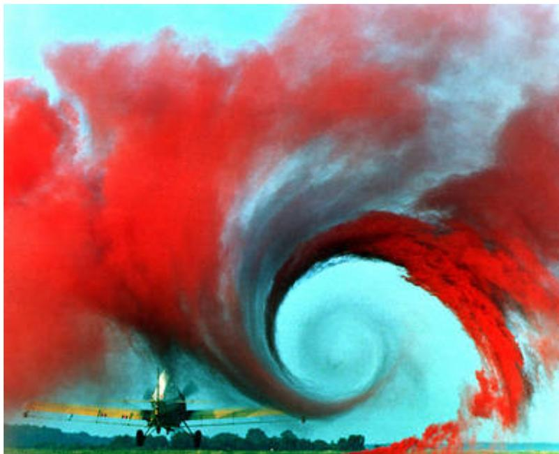
Photographie d'un tourbillon de sillage induit par un avion.
