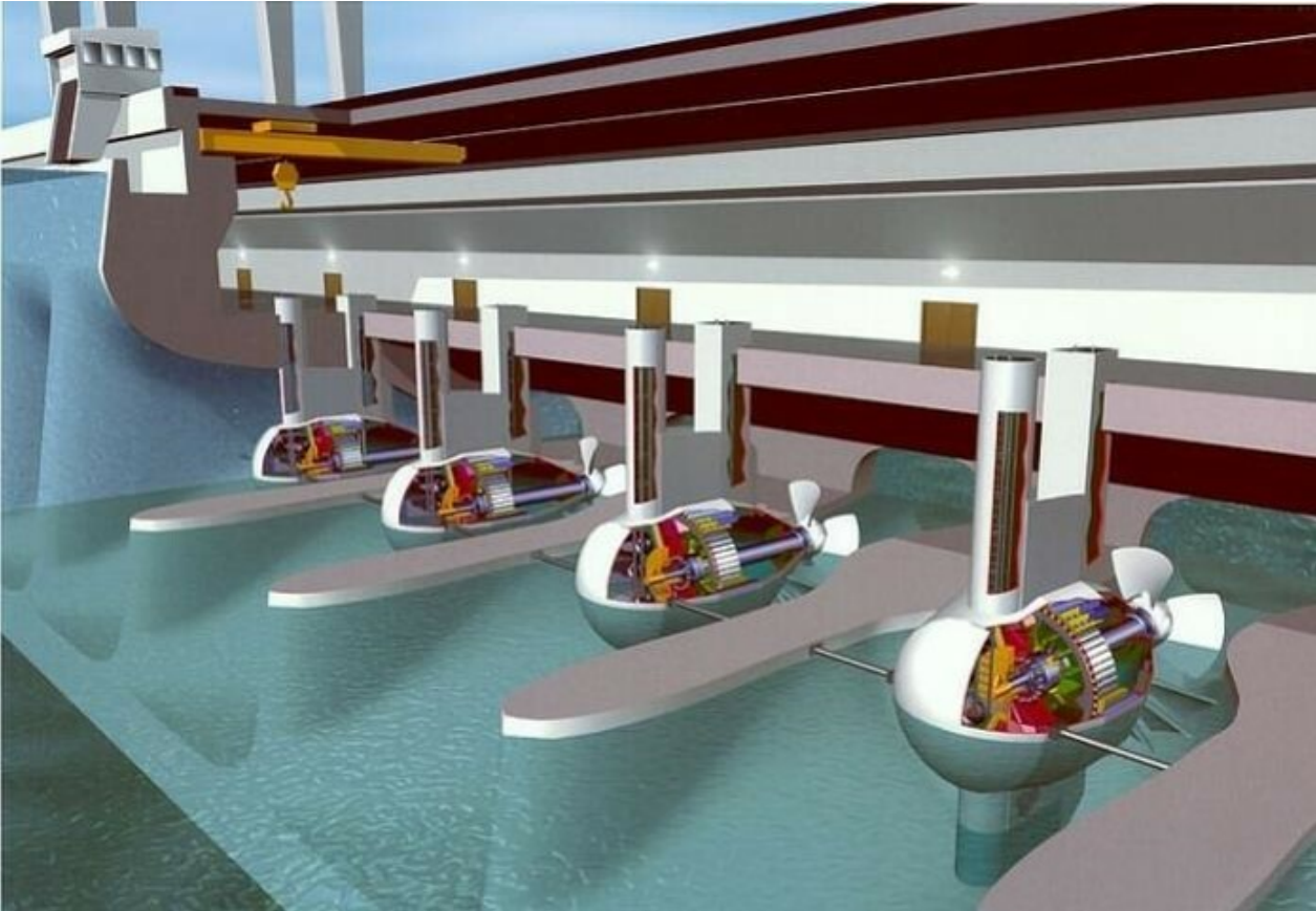
Coupe d'une centrale avec groupe bulbes
