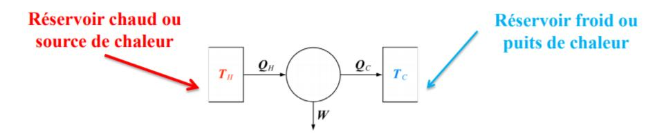
On fait généralement appel au cycle de Rankine, soit avec de l'eau, soit avec un fluide réfrigérant comme l'ammoniac ou le R-134a.
