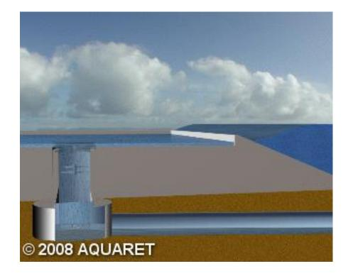
• Colonnes d'eau oscillantes: le mouvement de l'eau fait varier la pression de l'air, et cet air met une turbine en mouvement.
