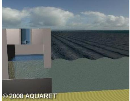
Dispositifs à structure articulée: le mouvement de l'eau modifie l'angle de deux (ou plus) segments d'un mécanisme; ces flexions sont converties, directement ou indirectement, en énergie électrique.
