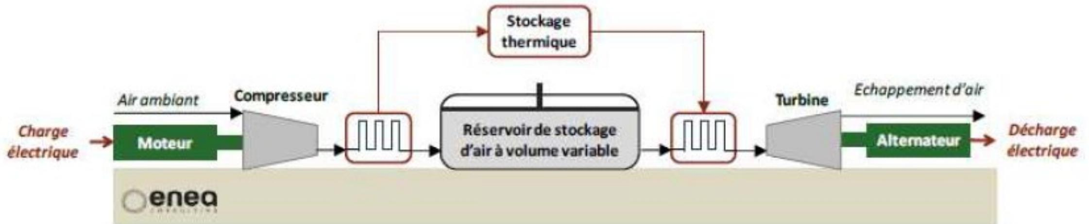
Schéma de principe du « CAES isobare adiabatique de surface »
