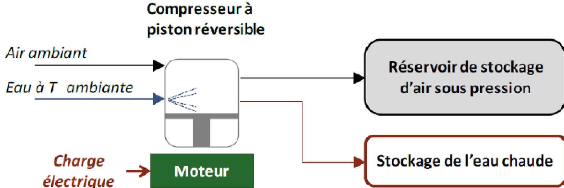
Schéma de principe du « CAES isotherme de surface »
