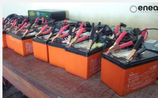
Figure 12 : Batteries utilisées pour du battery-swap en Tanzanie par EGG-Energy, social business accompagné par ENEA Consulting sous forme de mécénat de compétences
