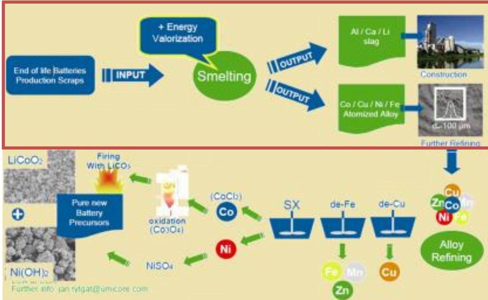
Pour une tonne de batteries entrant dans le procédé de recyclage, l'étape de smelting, comprenant le nettoyage des gaz, consomme 5000 MJ
