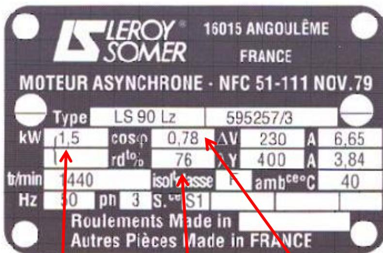
Puissance mécanique utile
