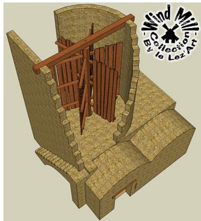
Moulin horizontal (à axe vertical), Perse
