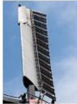
Aile profil Dekker avec aérofrein et système patent , moulin De Traanroeier, Oudeschild, Pays-Bas.
