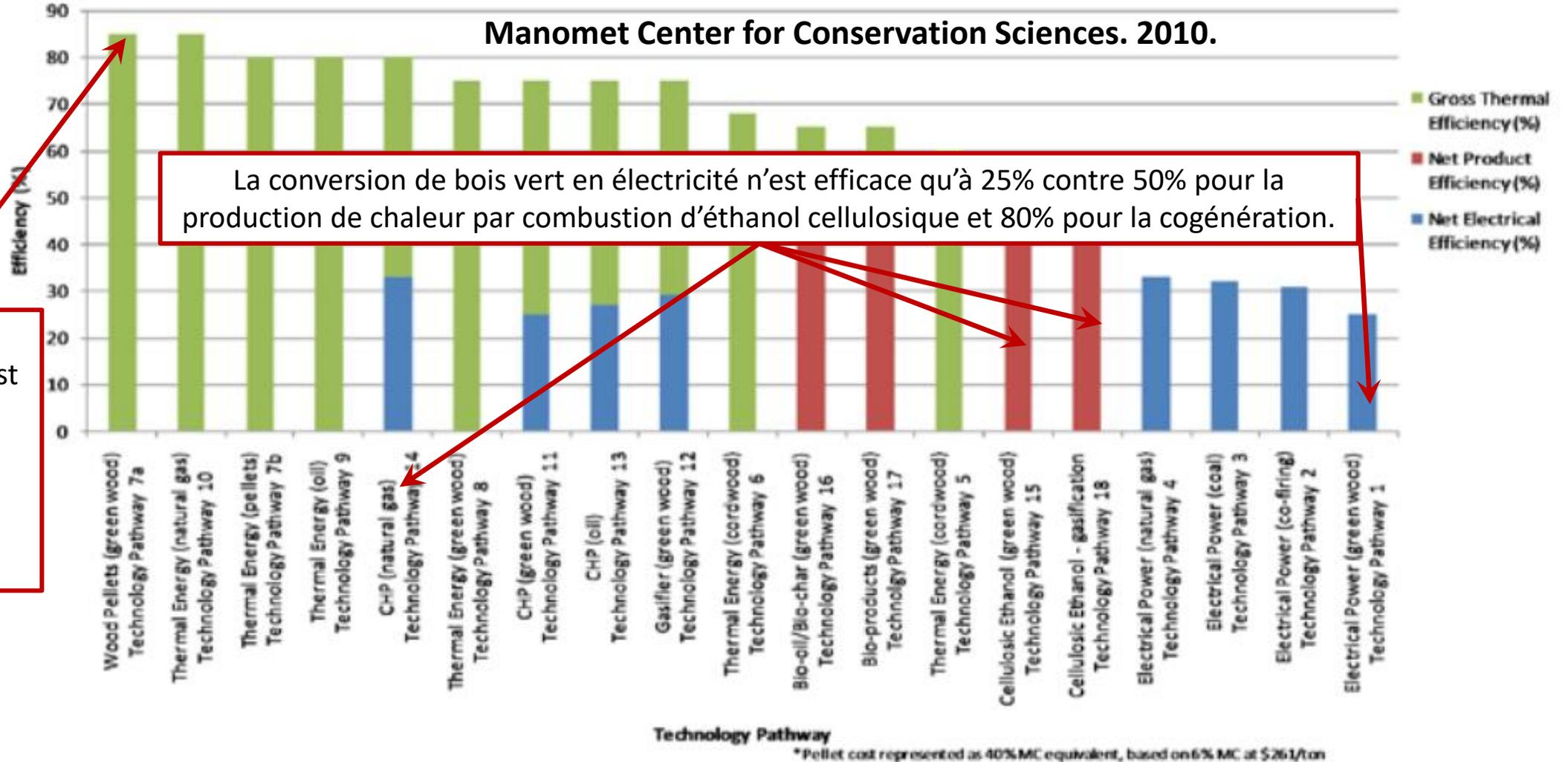
La conversion de bois vert en électricité n'est efficace qu'à 25% contre 50% pour la production de chaleur par combustion d'éthanol cellulosique et 80% pour la cogénération.
