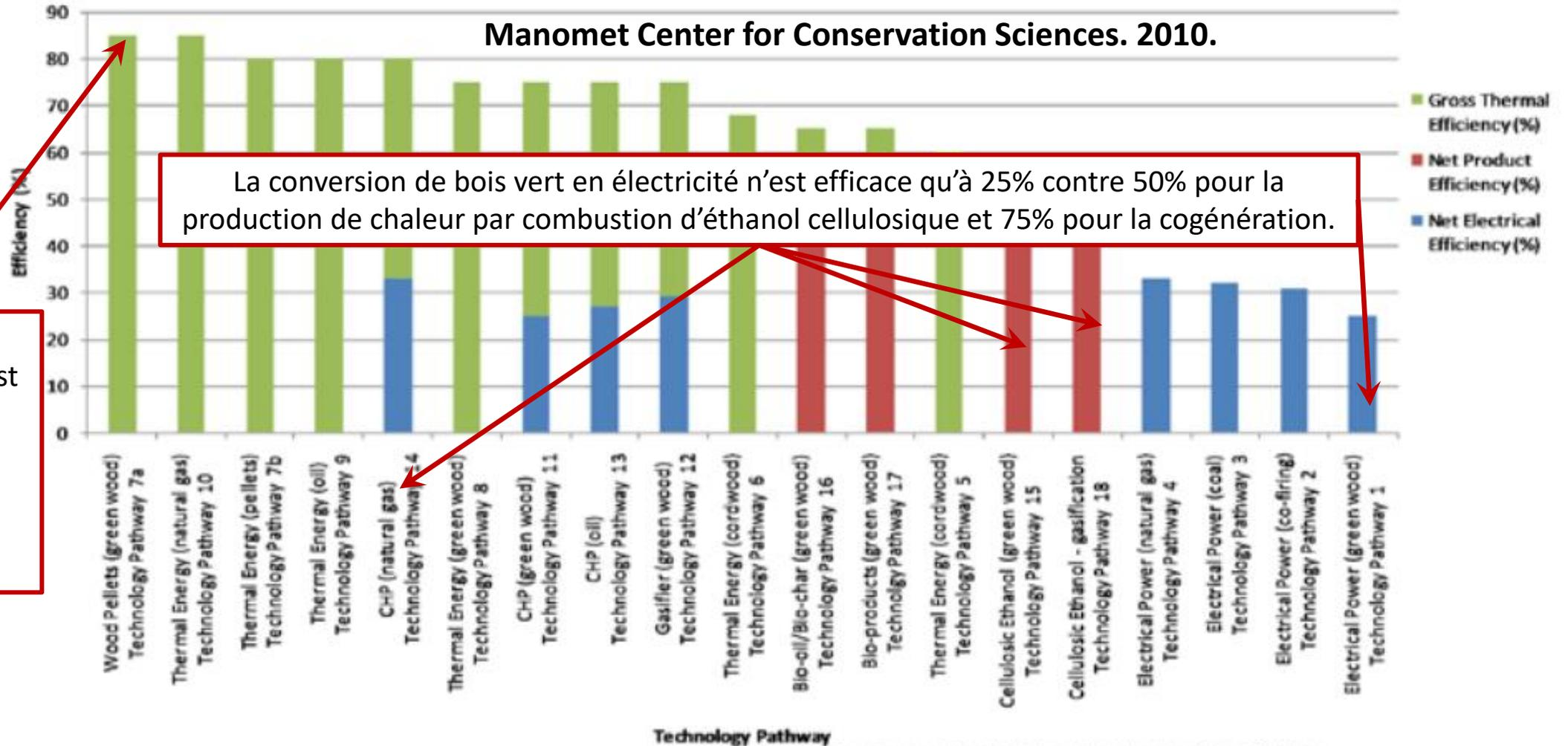
La conversion de bois vert en électricité n'est efficace qu'à 25% contre 50% pour la production de chaleur par combustion d'éthanol cellulosique et 75% pour la cogénération.
