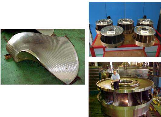
Aube et roues modèles et prototype
