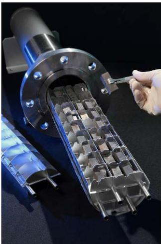
Un réservoir de stockage d'hydrogène sous forme d'hydrures métalliques de conception Liten.
