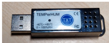
Figure 3.4 Un capteur capable de mesurer la température et le niveau d'humidité relative dans l'air. Les données sont communiquées à un ordinateur via un port USB.
