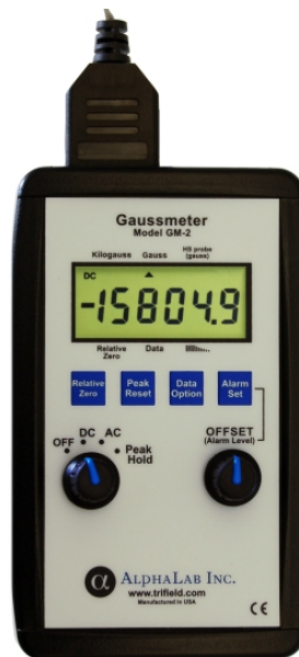
Figure 4 Gaussmètre AlphaLab GM-2.
