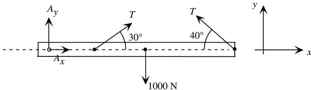
$A_x$  et  $A_y$  sont les deux composantes de la force de la rotule sur la poutre.
