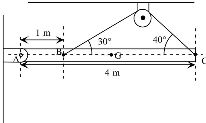
Diagramme de forces : (on se rappelle que la tension est la même dans la corde de chaque côté d'une poulie).
