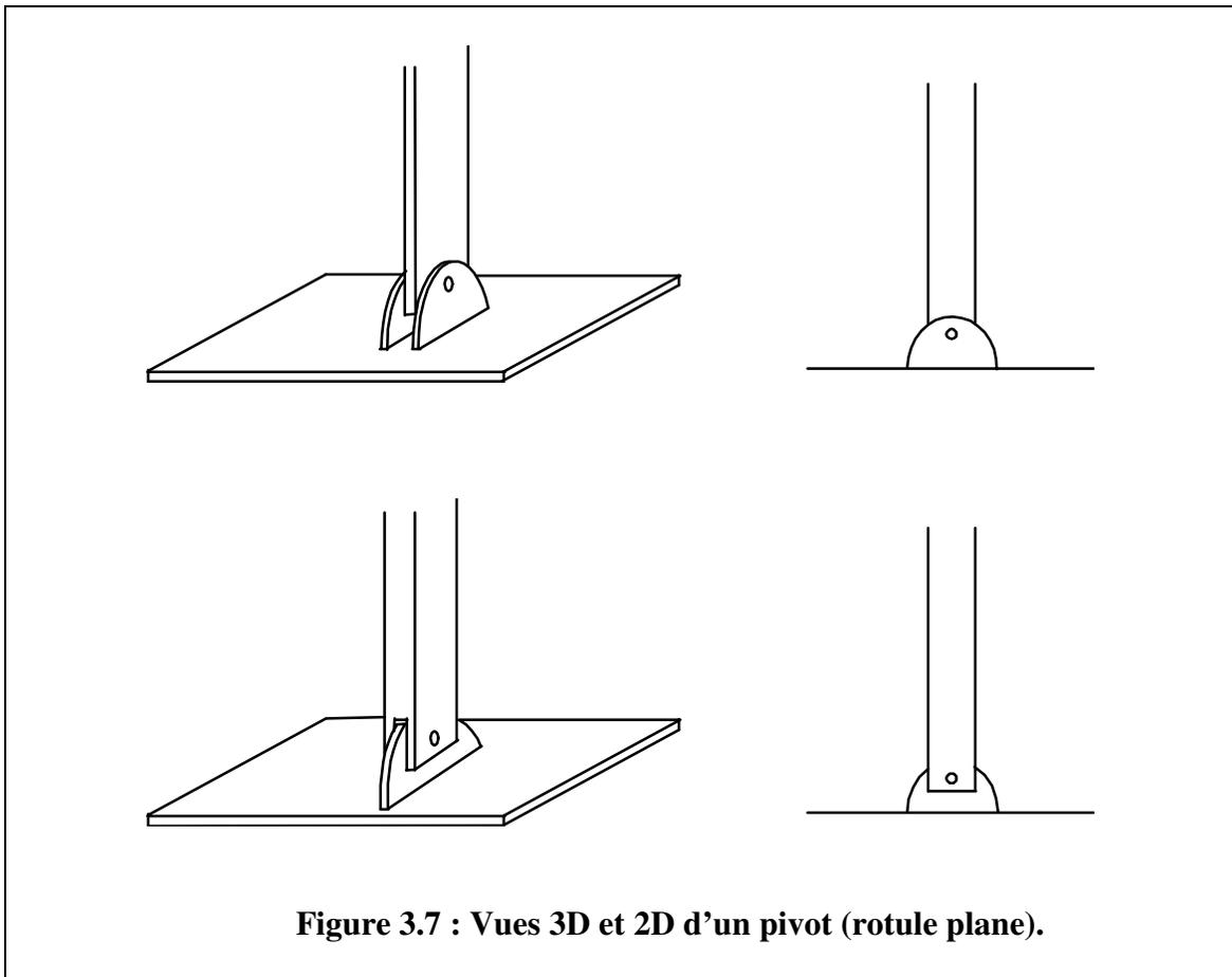
Figure 3.7 : Vues 3D et 2D d'un pivot (rotule plane).
