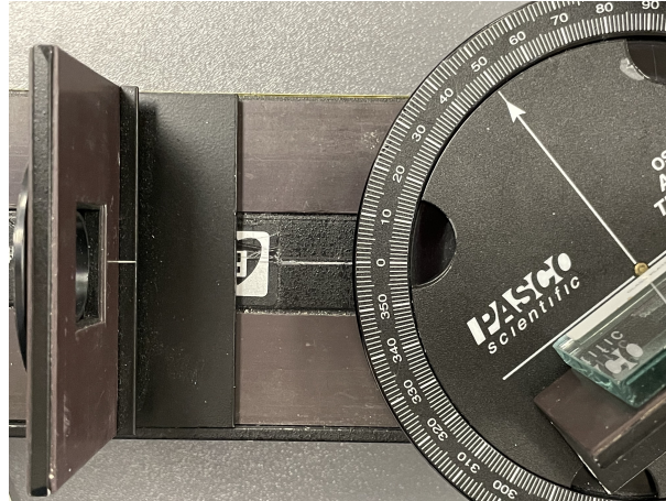
FIGURE 4 – Alignement de la lame de verre sur le plateau.
