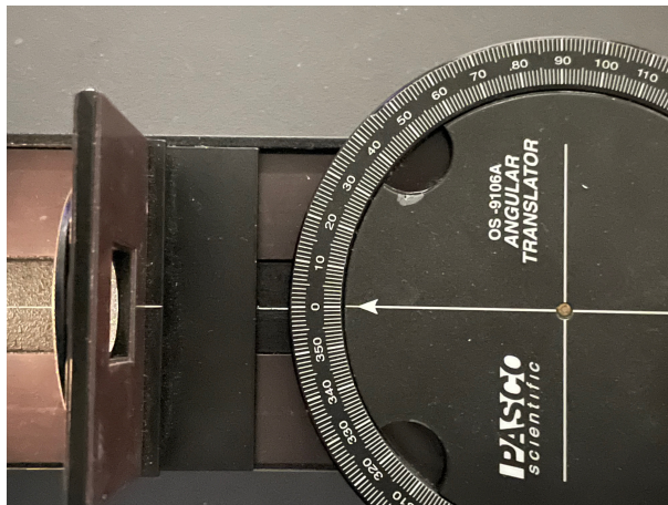
FIGURE 2 – Alignement du plateau avec la ligne centrale du rail.
